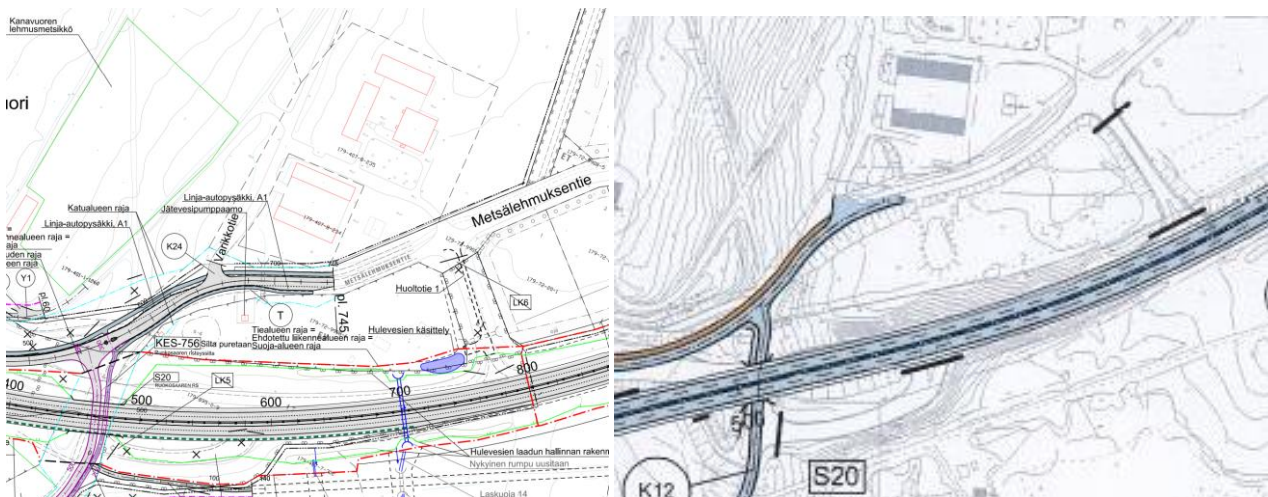
Vasemmanpuoleinen kuva: ote vuoden 2023 tiesuunnitelmakartasta vt 4 ja vt9 parantaminen välillä Kanavuori-Haapalahti (3T-5; V9 plv 280-2220, Revisio A). Oikeanpuoleinen kuva: ote vuonna 2015 laaditusta aluevaraussuunnitelmasta. Metsälehmuksetien ja Varikkotien risteys sekä vt9:n linjaus ovat eri tavoin ratkaistu.
